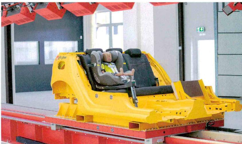
▲ La plataforma es impactada por un émbolo, para reproducir impactos frontales de hasta 80 km/h, laterales de entre 25 y 50 km/h, y choques posteriores de hasta 75 km/h.
