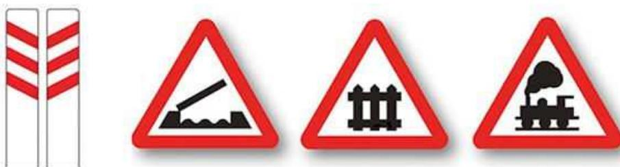
1. Paso a nivel o puente móvil (izquierda) y las señales triangulares que las acompañan.
